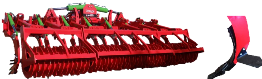
Rodillo de discos lisos y dentados diámetro 520-550 mm
